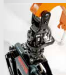
Fixation du rotator avec frein d'oscillation
