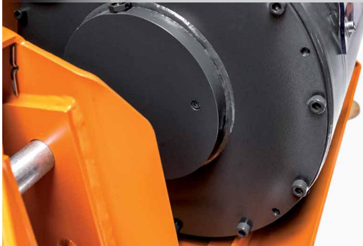
Extraction du câble avec frein sur enroulement
