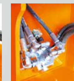
Vanne à voies (à commande électrique)
