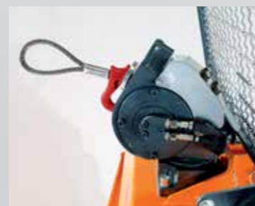
Extraction du câble avec frein sur enroulement
