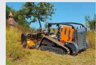
Perfekte Kombination von Winde und Raupe als Fällhilfe
