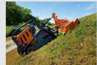
Bodenschonender Einsatz im Gelände durch geringen Bodendruck
