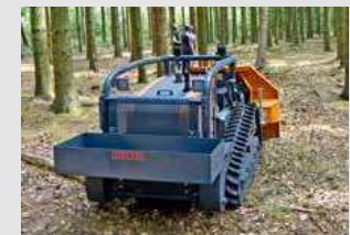
Perfekte Kombination von Winde und Raupe als Fällhilfe
