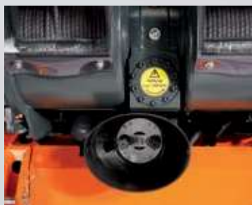
DUO Zapfwelle für Front- und Heckanbau (Option)
