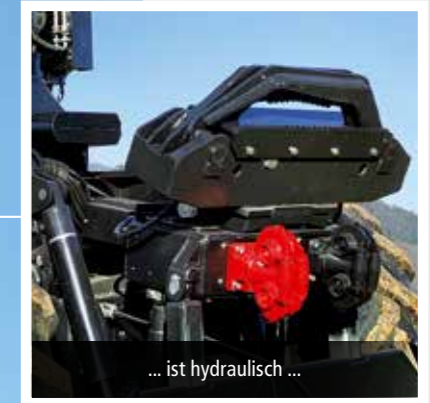
Die Klemmbank des Skidders ...
