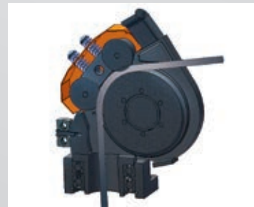
Seilauswurf mit zwei integrierten Andruckrollen
