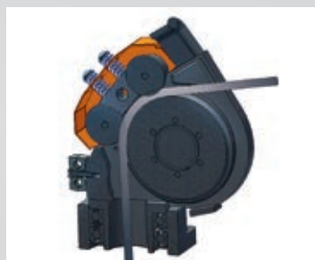
Seilauswurf mit zwei integrierten Andruckrollen
